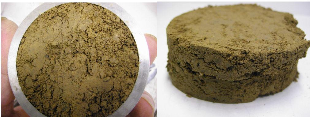
図 5.13 乱さない供試体のせん断前後の状態 (Φ=6 cm × H=2 cm)
