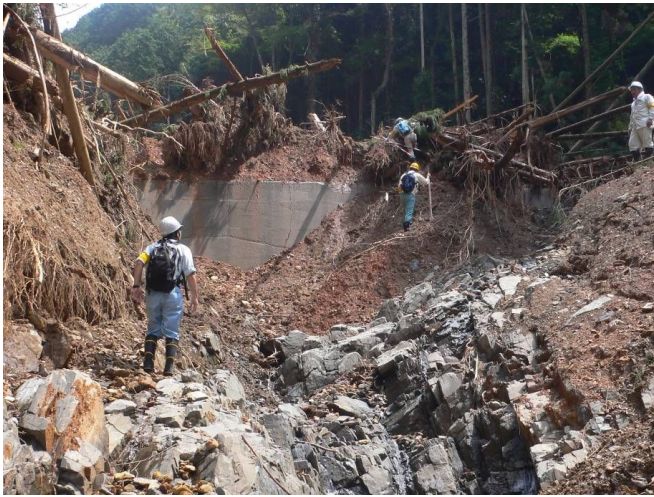
図 3.7 崩壊地の下部に見られる縦亀裂が発達した頁岩
